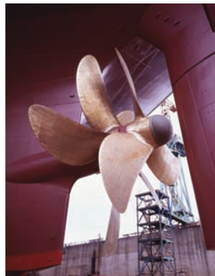
二重反転プロペラ (写真提供：三菱重工業)
