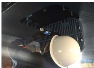
検査対象船舶の海水取入口 を撮影中の検査官
