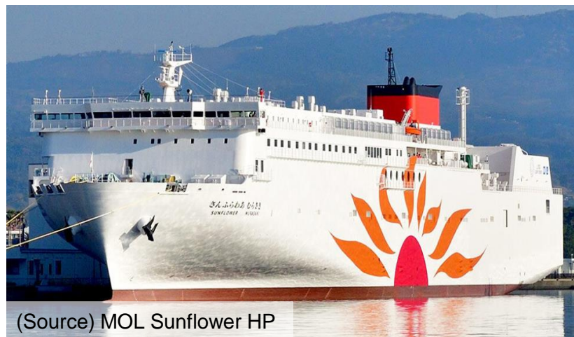
LNG fueled vessel (domestic ferry)
