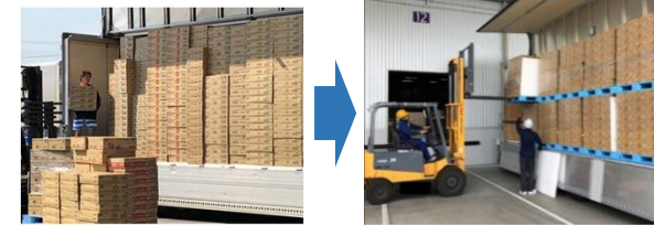
バラ積み・バラ降ろしによる非効率な荷役作業 パレットの利用による荷役時間の短縮
