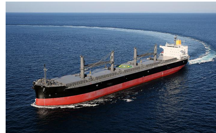
載荷重量 6万2千トン 全長200.00m/幅32.26m/深さ18.97m
