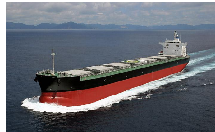
載荷重量 8万2千トン 全長229.00m/幅32.26m/深さ19.98m
