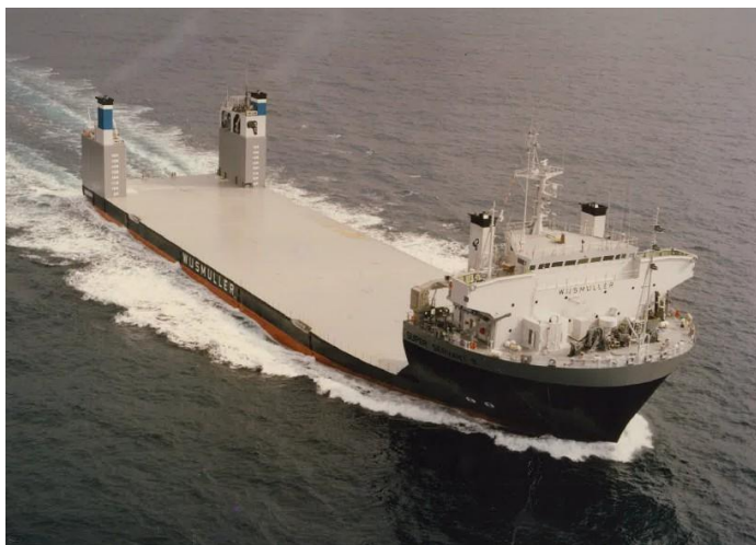
半没水式重量物運搬船(7隻)
