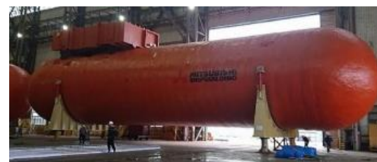
現在のLNG燃料タンク、燃料供給システム（三菱重工）
