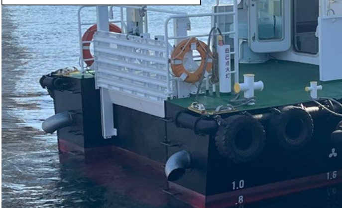
落水者救助用船尾側昇降機
